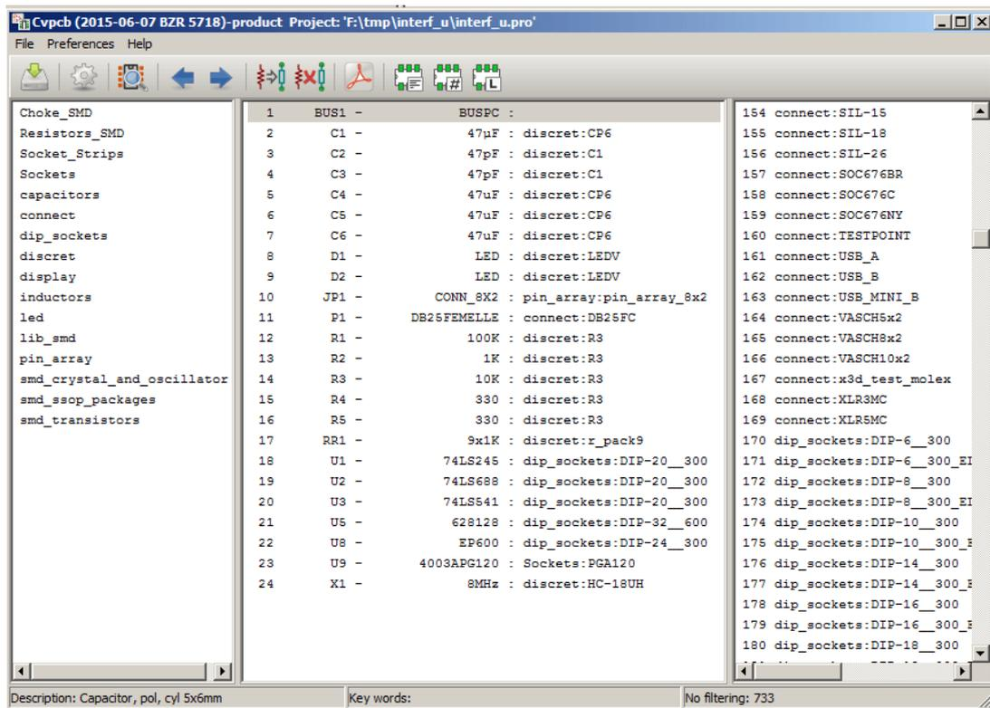
Filtrage par la liste des filtres d'empreintes affectés au composant sélectionné. Les filtres de composants sont répertoriés dans le volet central de la barre d'état au bas de la fenêtre principale.
